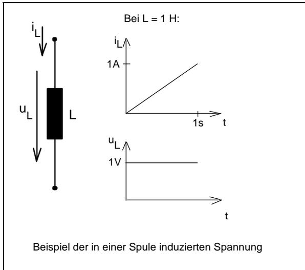
Eine Spule hat eine Induktivität von 1 Henry, wenn in ihr bei gleichmäßiger Änderung des Spulenstroms von 1 A in 1 Sekunde eine Spannung von 1 V induziert wird.
