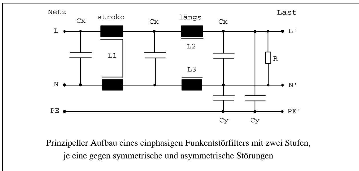
Bei symmetrischen Störungen durch Kommutierungseinbrüche von Gleichrichtern oder Thyristor- oder Phasenanschnittsteuerungen setzt man zunächst X-Kondensatoren steigender Kapazität ein. Reichen diese nicht aus, setzt man zusätzliche Längsdrosseln auf Eisenpulver-Kernen ein. Diese werden üblicherweise zur Last hin eingesetzt, während die Drossel zur Netzseite hin eingesetzt wird.
