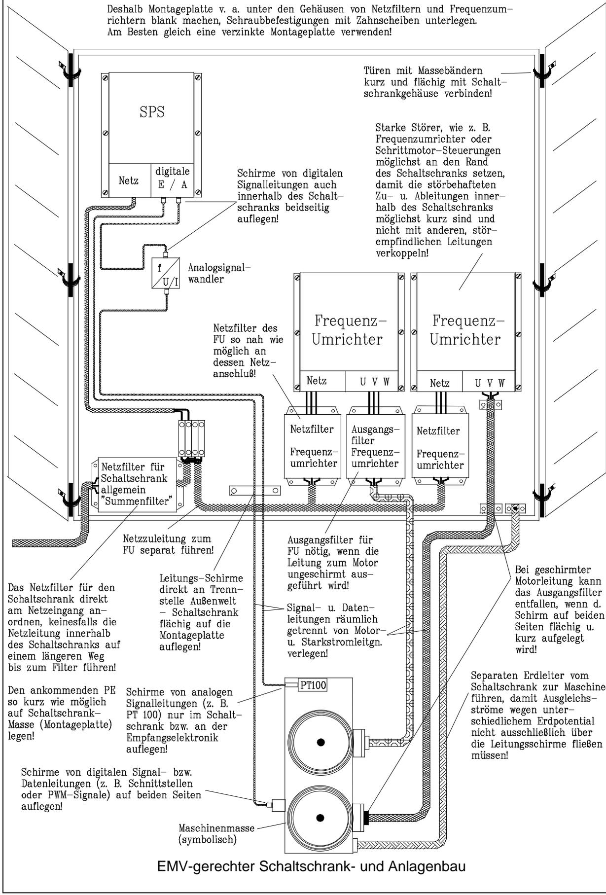
Türen mit Massebändern kurz und flächig mit Schaltschrankgehäuse verbinden!
