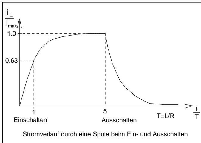
Wird der Strom abgeschaltet, baut sich das Magnetfeld wieder ab. Dabei wird im Leiter ein Strom induziert, der zeitlich exponentiell abnimmt, bis das Magnetfeld vollständig abgebaut ist, d. h. die Spule wird kurzzeitig zu einer Stromquelle. Die Energie steckt also in dem magnetischen Feld um den Leiter und stellt eine elektromagnetische Trägheit dar, die versucht, sich jeder Änderung des Stromflusses durch den Leiter zu widersetzen.
