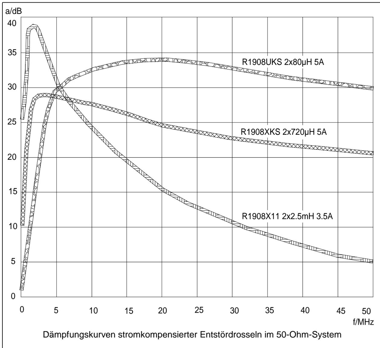
Die drei Dämpfungskurven in obigem Diagramm sind von drei verschiedenen Standard-NKL-**Entstördrosseln** aufgenommen, die alle **auf Ferrit-Ringkernen** mit denselben geometrischen Abmessungen gewickelt wurden:
