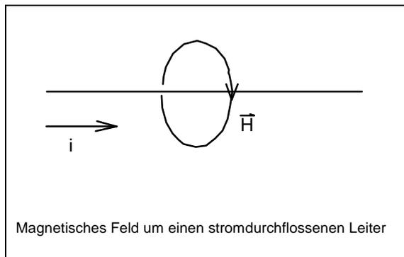
Die einfachste Spule ist ein elektrischer Leiter, um den herum sich ein magnetisches Feld aufbaut, sobald er von einem Strom durchflossen wird.
